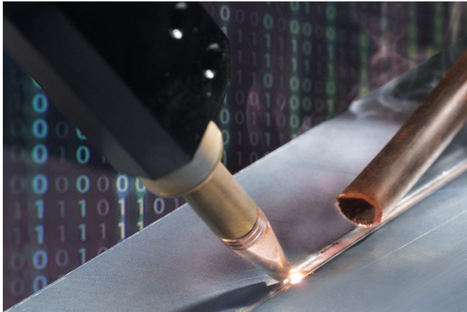
Bild 2: Künstliche Intelligenz ermöglicht die Regelung von Fertigungsprozessen wie dem Laserlöten in Echtzeit. © Fraunhofer ILT, Aachen.
